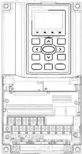
Силовые клеммы: R/L1, S/L2, T/L3, U/T1, V/T2,
