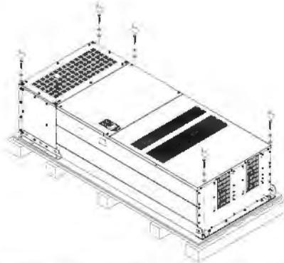
Открутите 6 винтов M6 с двух сторон и удалите 2 планки как показано на рис. ниже. Винты и планки могут быть использованы для внешнего крепления преобразователя.
