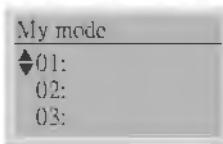
Если нажать кнопку F4 на странице выбора параметра, то он сохранится в разделе "Мой режим". Для удаления или изменения параметра выделите его и нажмите "DEL" в правом нижнем углу.
