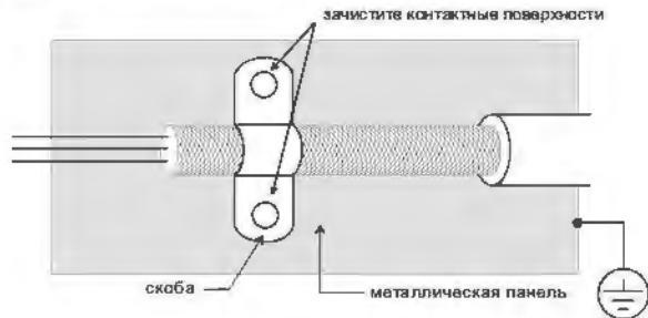
Заземление экрана на обоих концах кабеля
